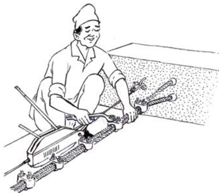
चित्र ८.७: लट्टा कस्ने ग्रीपका नटहरु पालै पाले गरी कस्दै गरेको
