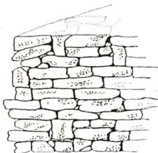
चित्र २.२५ दुङ्गाहरूको सल नमिलाई बनाइएको गारो (बेठीक तरिका)
